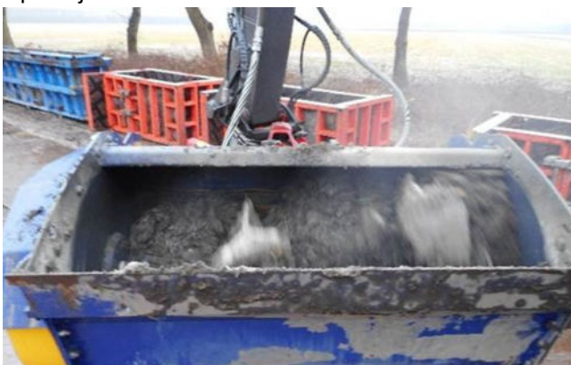
Figuur 17. Mixen van slib met andere stoffen (links) en geperste legoblokken (rechts), (Foto: eemsdollard2050.nl).
