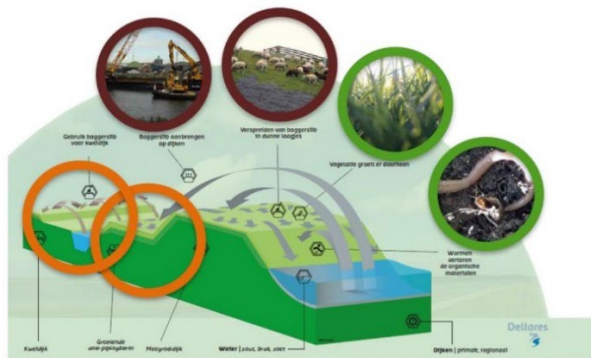
Figuur 25. Schematisch overzicht van de Meegroeidijk (links), waarin de dijk, de anti-piping berm en de kweldijk worden geïllustreerd die geleidelijk groeien door herhaaldelijke toepassing van dunne lagen baggermateriaal (rechts), dat direct op de dijk rijpt tot klei (Fotos: EcoShape, 2021 en Doornebal et al., 2023).
